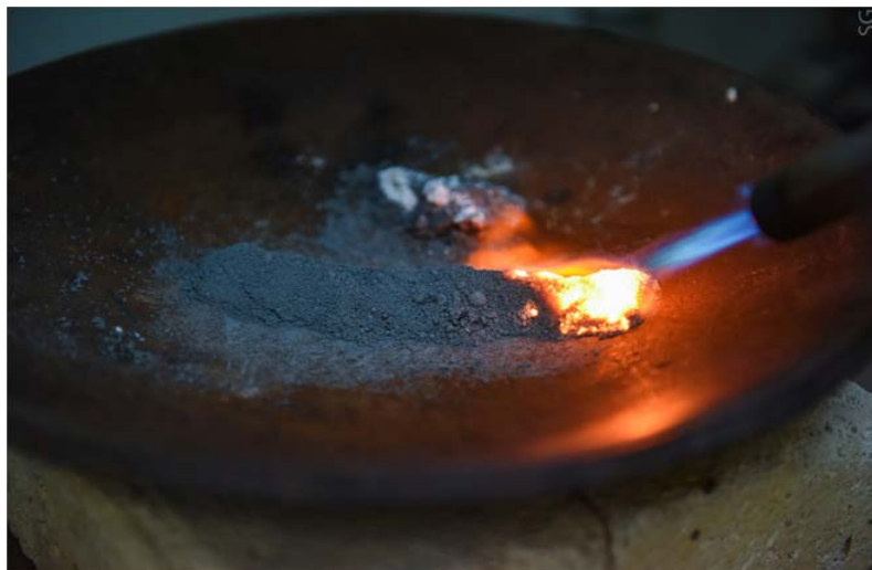
该项 3D 打印技术的关键在于燃烧铝粉获得了前驱体改性剂
