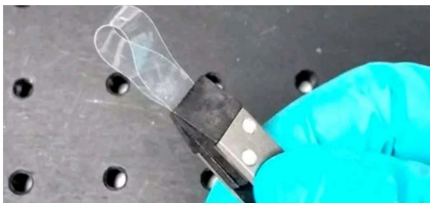
被称作“液晶弹性体”的首个拉胀材料
