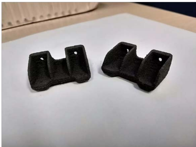
美空军研究实验室 3D 打印增强树脂基高温复合材料部件
