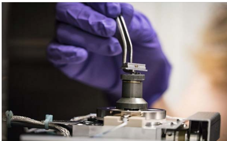
高温合金样品在聚焦离子束铣削显微镜下制成薄片
