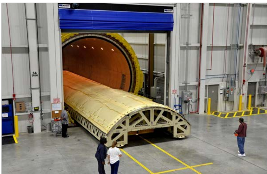
传统热压罐固化装置
